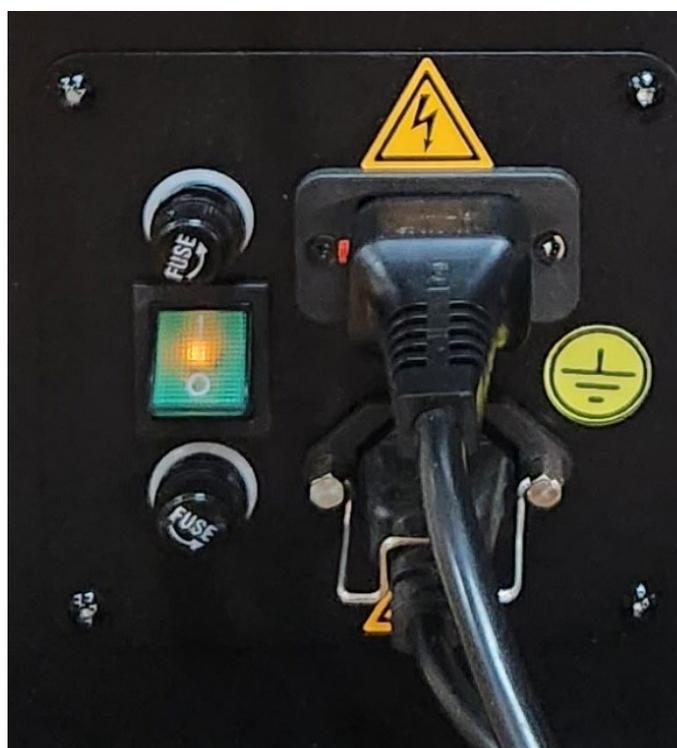
Рис. 10.2 Отдельное заземление высоковакуумного поста
