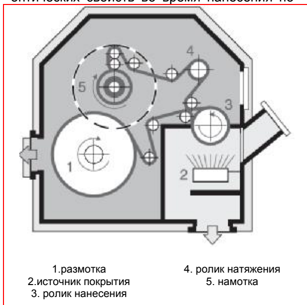
Рисунок 7.6. Схема вакуумной системы нанесения покрытия на пленочные материалы
